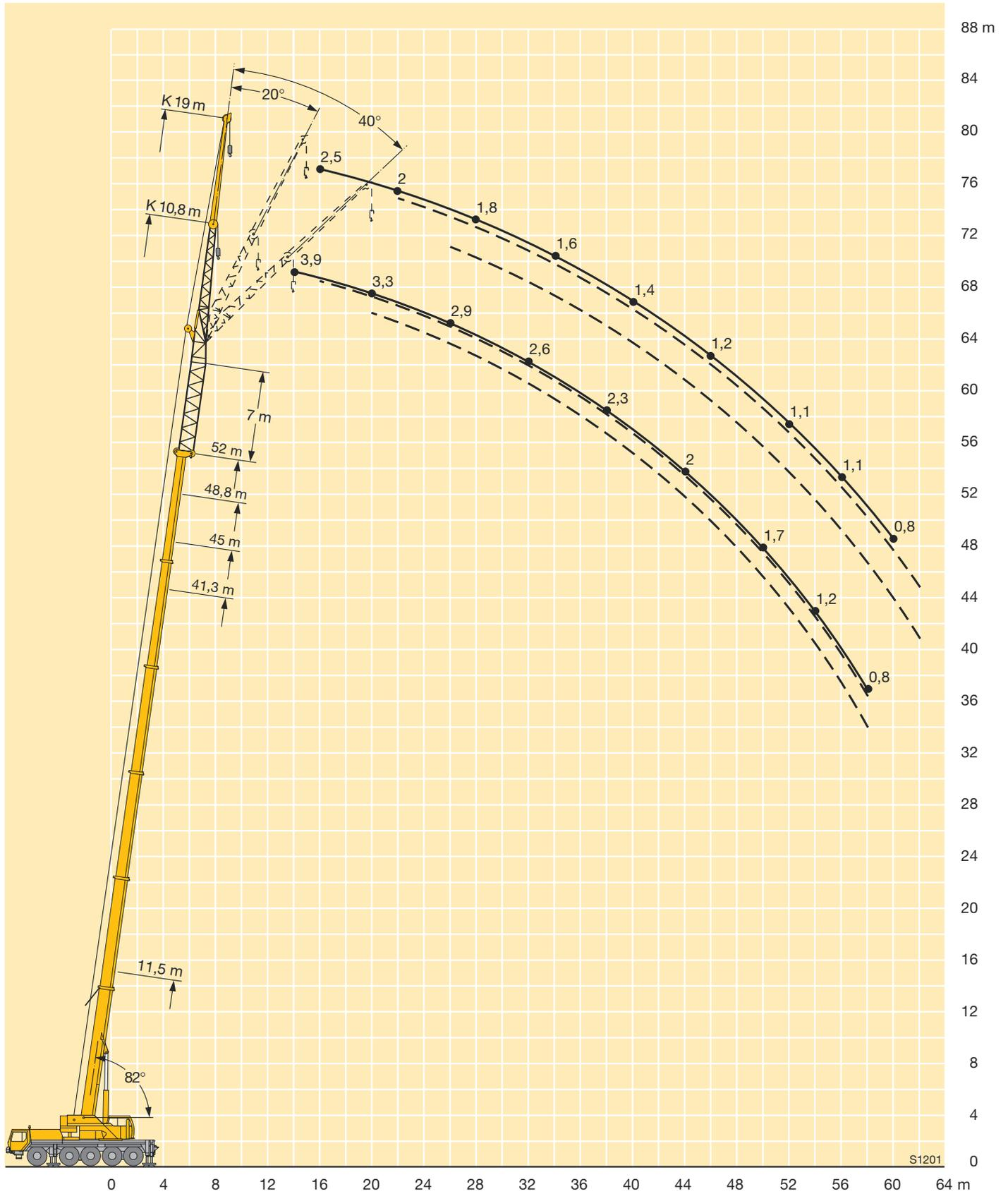
**Traglasten an der hydraulisch verstellbaren Klappspitze
