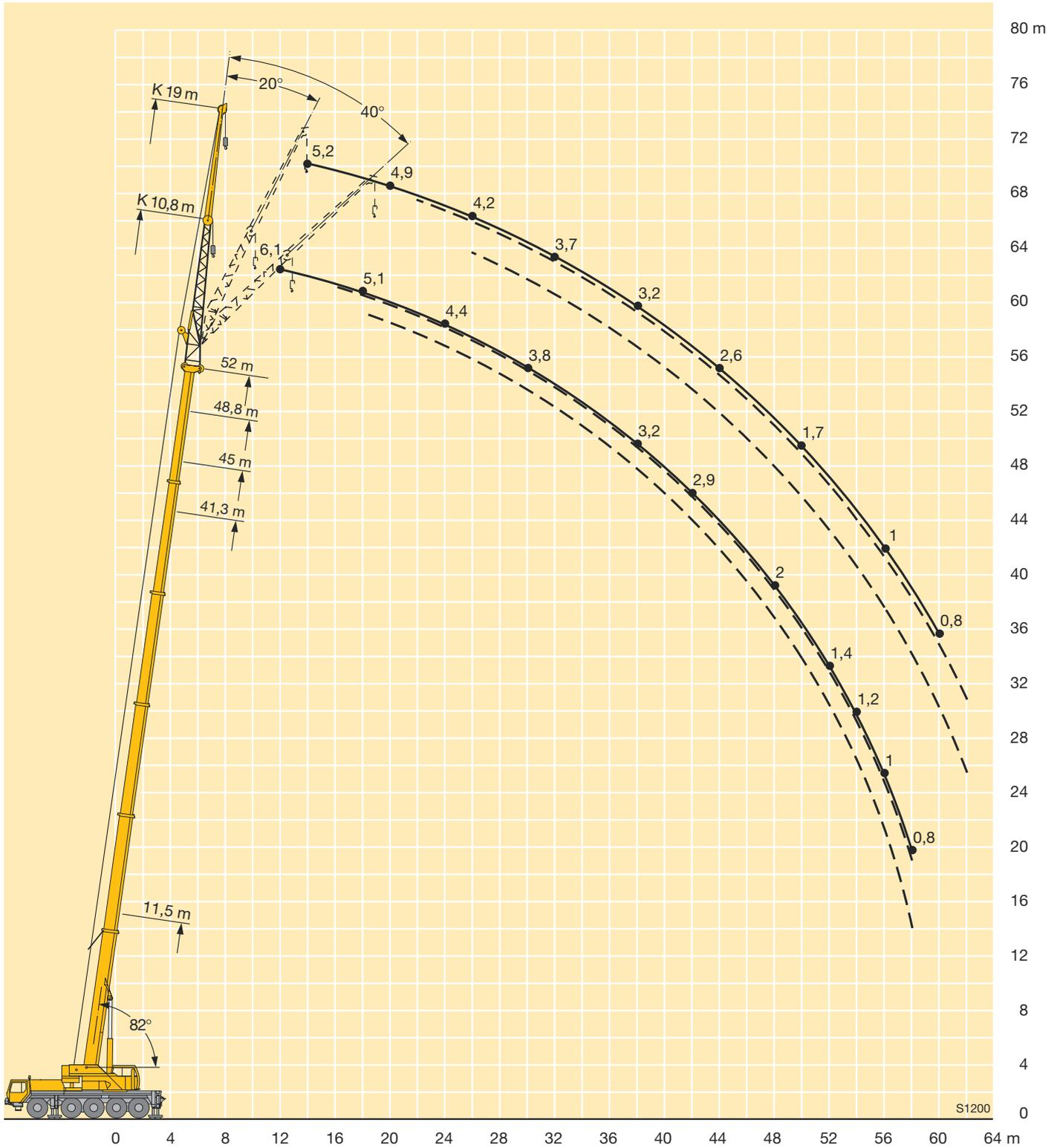
**Traglasten an der hydraulisch verstellbaren Klappspitze
